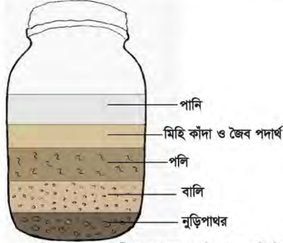
চিত্র ১৩: জার পরীক্ষার মাধ্যমে মাটির প্রকার নির্ণয়
